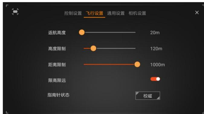
此界面可对返航高度、飞行距离限制、飞行高度限制等参数进行设置。本产品允许的最大飞行高度为 500 米，强烈建议您将最大飞行高度限制在 120 米以内，飞行高度超过 120 米产生的一切后果请自行承担。
