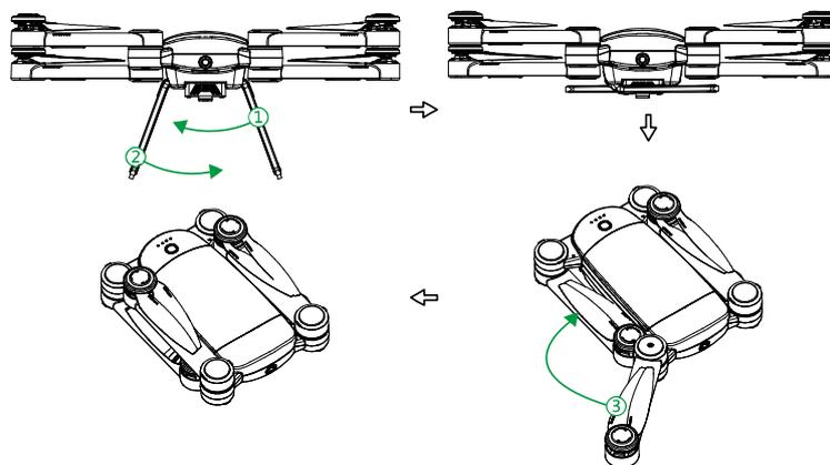
※ 在展开飞行器的过程中，请控制旋转机臂和脚架的力度。到达结构限位后，请停止转动。
