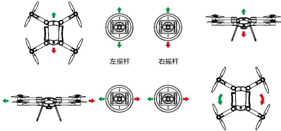
遥控器出厂默认操作方式为“美国手”，您可以通过遥控器调参软件或进入“App 控制设置”界面更改遥控器的操作模式。（详情参见 APP 控制模式设置）
