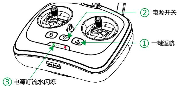
3. 连续按下飞行器电源按键五次，遥控器发出一声提示音，等待数秒，完成对频。此时，遥控器状态指示灯显示绿灯常亮。
