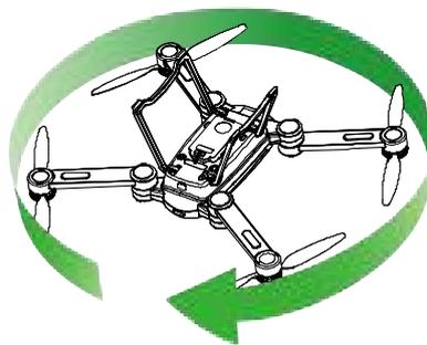
4. 手握飞行器，机头向下，垂直方向顺时针旋转飞行器。观察飞行器指示灯颜色，当出现机头黄灯长亮，机尾绿色常亮时，校磁成功；若机臂下的指示灯全部变黄，则校磁结果
