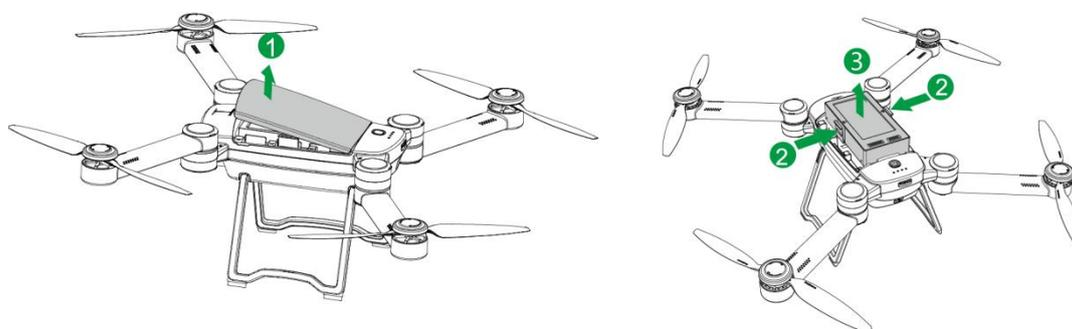
※ **取下电池前，请先关闭飞行器电源。**
