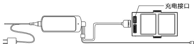
充电时，充电器上的指示灯为红色，表示正在充电；当指示灯变为绿色时，表示电已充满，请及时断开充电器。
