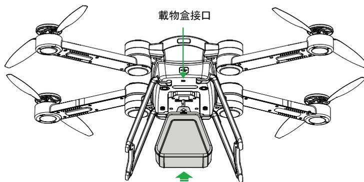
拆卸时，需先开启飞行器和遥控器电源，然后执行投放命令，载物盒会自行脱离飞行器。
