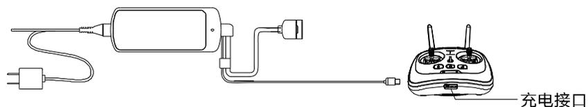
对遥控器充电时，请通过遥控器电量指示灯的颜色来判断是否充满。遥控器电量指示灯红灯闪烁，表示正在充电；绿灯常亮，表示电已充满。遥控器充电时间一般在 5 小时左右，充满电可以使用约两周时间。
