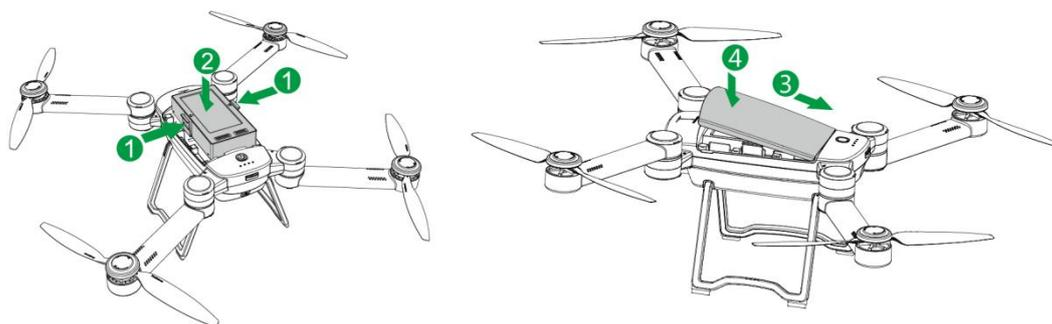
飞行完成后，请取出电池。按图中所示方法，先取下电池舱盖。然后，同时按压电池两侧的卡扣，并向上提起，便可拆除电池。
