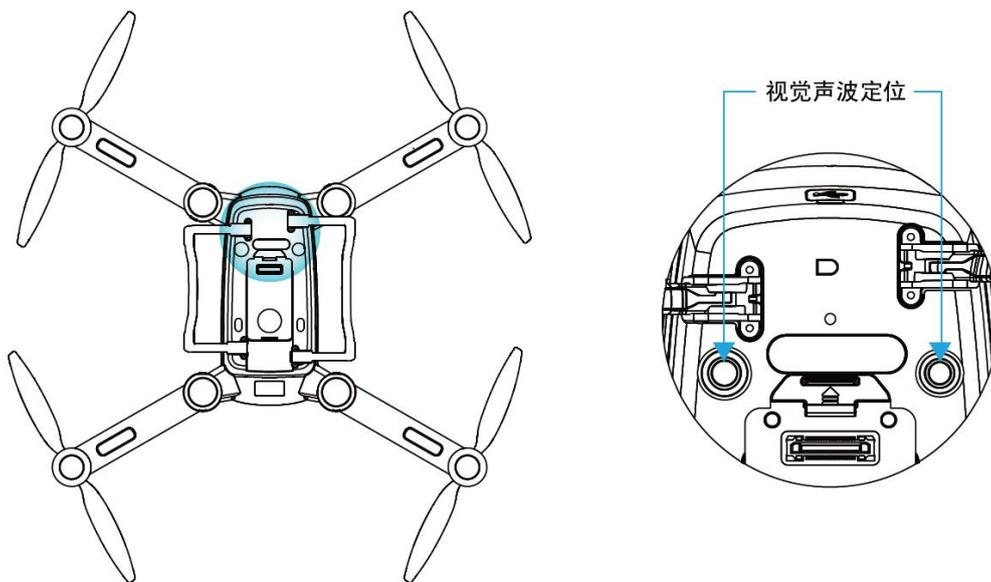
视觉声波定位系统适用于高度为 6 米以下、无 GPS 信号或 GPS 信号欠佳的环境，特别适用于室内飞行。
