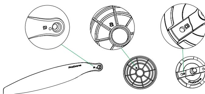
安装螺旋桨时，先根据电机上的字母选择相同类型的螺旋桨，将印有字母的桨面朝上，套入电机上的螺旋桨限位销。然后，将螺旋桨压片沿垂直于限位销连线的方向，压入电机转轴的卡槽。90 度旋转压片，使两端的孔位对准限位销，用力压入。最后，按照桨帽上的方向指示拧紧桨帽。
