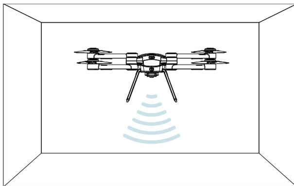
视觉声波定位系统的精度容易受光照强度、物体表面纹理情况所影响，而且超声波会在某些吸音材料上会出现不能正常测距的情况。如果在视觉和超声波均失效的情况下，系统飞行模式会自动切换至姿态模式。所以，请勿在以下环境中使用此功能：
