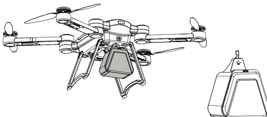
执行载物投放之前，需要进入 APP 控制设置界面对自定义功能按键 C1 或 C2 进行功能定义，选择“舵机控制”。然后，将需要投放的对象放入载物盒中，并将载物盒插入舵机孔中。操作飞行器到达投放点上空，按下 C1 或 C2 按键，载物盒将脱离飞行器，完成投放。
