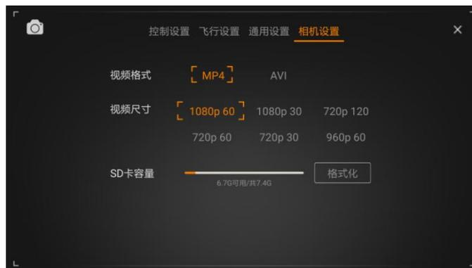
此界面可对照片格式、视频格式、视频分辨率进行设置（需对云台上电才能设置）。
