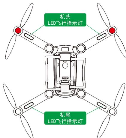
两组 LED 灯通过颜色和闪烁状态的不同组合来指示当前飞控系统的状态，具体定义请参见下表。
