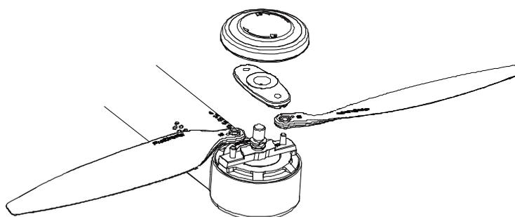
拆卸螺旋桨时，先按桨帽上的方向提示取下桨帽。然后，微微向上提起压片，旋转 90 度后，取下压片。最后，取下螺旋桨。
