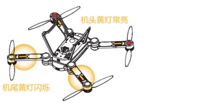
▲请将机腹朝上，水平顺时针旋转飞机；
