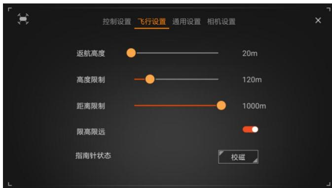
此界面可对返航高度、飞行距离限制、飞行高度限制等参数进行设置。本产品允许的最大飞行高度为 500 米，强烈建议您将最大飞行高度限制在 120 米以内，飞行高度超过 120 米产生的一切后果请自行承担。
